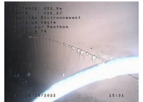
Fissures apportant des eaux claires parasites
